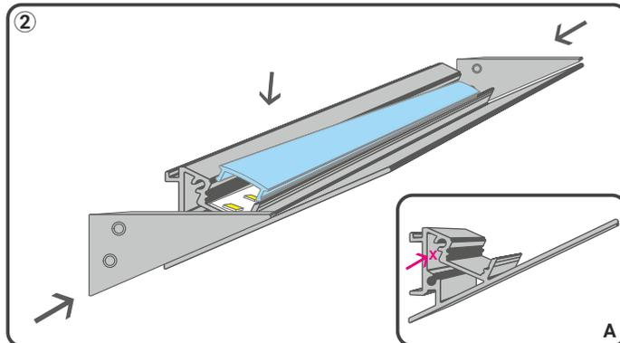
Applicare i tappi e se richiesto fissarli con le viti in dotazione, quindi inserire la copertura. L'uscita del cavo di alimentazione è posteriore (forare la parte del profilo indicata nella figura A).
