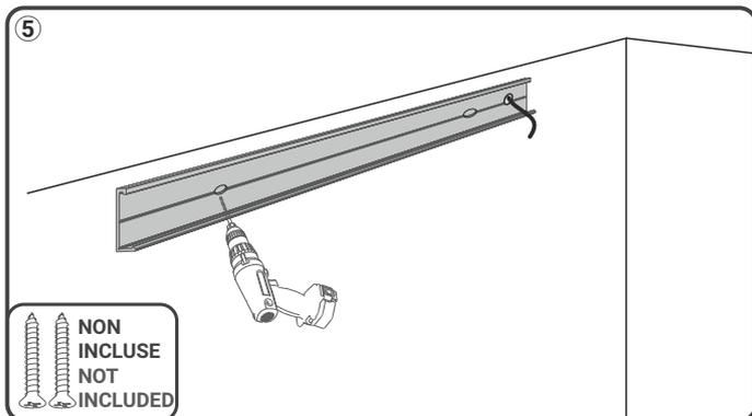
Effettuare i fori di fissaggio sulla staffa mantenendo l'interasse precedentemente stabilito. Realizzare foro per l'uscita cavo.
